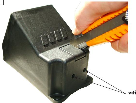
Per il montaggio del selettore, asportare parte del carter (10000270065) servendosi di un taglierino. Dare dei leggeri colpi in corrispondenza dei pretagli e non nel centro della parte da asportare. Rimuovere la predisposizione delle viti servendosi di un punteruolo.
