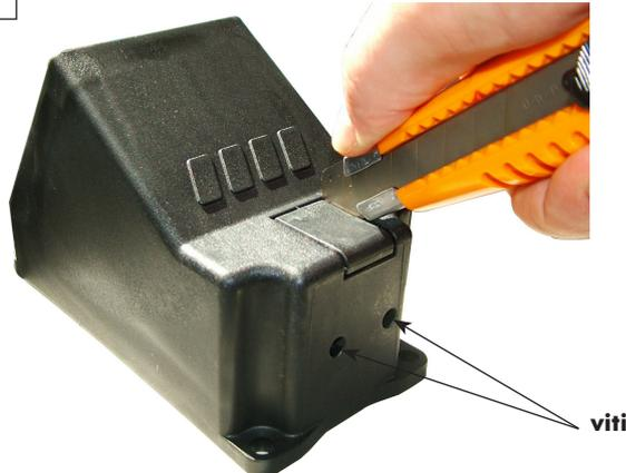
Per il montaggio del selettore, asportare parte del carter (10000270065) servendosi di un taglierino. Dare dei leggeri colpi in corrispondenza dei pretagli e non nel centro della parte da asportare. Rimuovere la predisposizione delle viti servendosi di un punteruolo.
